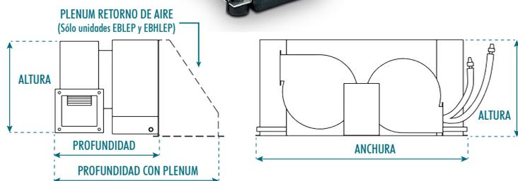
EBLE indica unidad base sin calefacción eléctrica o plenum de aire de retorno, EHBLE indica unidad con calefacción eléctrica, pero sin plenum de aire de retorno, EHBLEP indica unidad con calefacción eléctrica y plenum de aire de retorno. Los valores de altura mostrados son desde la superficie de montaje hasta la parte superior de la bobina con los ventiladores en posición horizontal
