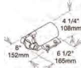
Bomba de alimentación
