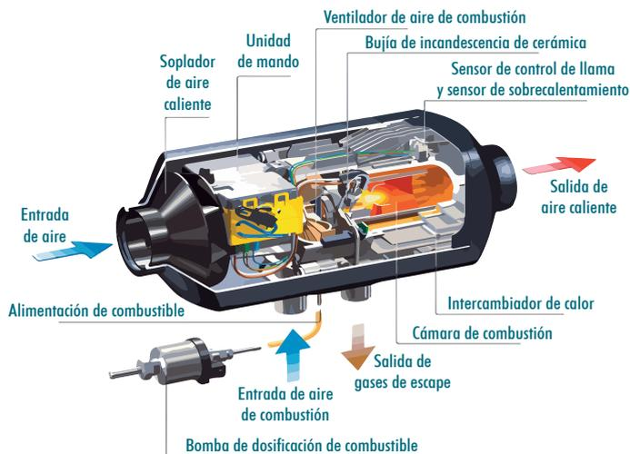
Un calentador compacto y económico. El Airtronic ofrece eficiencia de combustible optimizada, una gama de modos de operación y estándares de seguridad sin igual. Las aplicaciones incluyen: Calefacción independiente programable (no utiliza el calor del motor) para todo tipo de uso en carreteras y marinos. Certificado para instalación en áreas de pasajeros y cerca de sustancias peligrosas.
