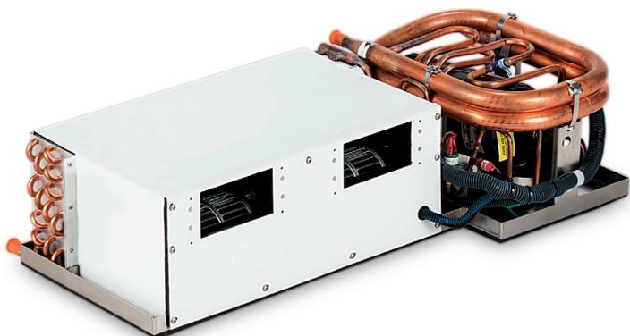
El sistema de aire acondicionado compacto Low-Profile está diseñado para instalaciones específicas. Gracias al innovador diseño horizontal del compresor y las turbinas duales tangenciales de alta eficiencia, puede ser instalado en espacios con muy poca altura, haciéndolo ideal para flybridge, cabina e instalaciones en cubierta.
