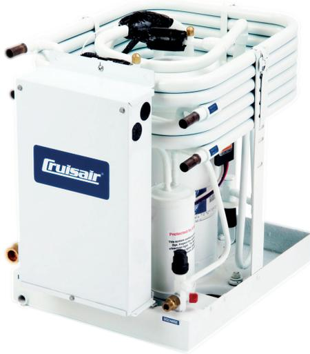
Nuevo diseño compacto de una sola pieza, el cuadro eléctrico con 1 m de cable puede montarse a distancia simplemente quitando un tornillo. Los puertos de servicio adicionales han sido añadidos para facilitar la carga y mantenimiento. Unidades disponibles desde 24.000 a 42.000 Btu/h. Los nuevos modelos de unidades RM tienen importantes mejoras. Compresores de mayor eficiencia para ofrecer plena capacidad, incluso bajo cargas pesadas.
