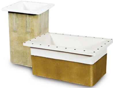
Existen bases de montaje que se adaptan a todos nuestros propulsores retráctiles para facilitar la instalación. Fabricados en PRFV isoftálico, pueden integrarse fácilmente en las nuevas construcciones o en la instalación posterior. Los yates de aluminio se adaptan a las bridas de aluminio. Están diseñadas para ser soldadas a la parte superior de una base de montaje construida en el casco.
