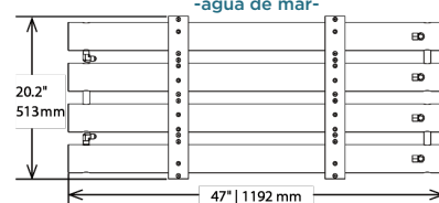
Montaje membrana -agua de mar-
