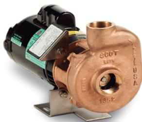
Bombas de agua fiables y de gran potencia para su uso en el agua de mar y el agua circulante de los sistemas. Todas las bombas son centrífugas, con componentes de bronce y acero inoxidable. Las bombas están disponibles con 115/230V monofásicas, o 230/460 trifásicas, con motores de doble voltaje. La mayoría son clasificadas para uso de 50/60 Hz.
