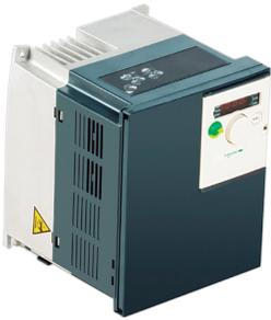
La unidad de frecuencia variable (VFD) elimina completamente la corriente de arranque al activar el compresor aumentando la tensión y la frecuencia en un periodo de tiempo controlado. Esto permite que se pueda operar con poca potencia en el muelle y también protege al generador de sobrecarga.
