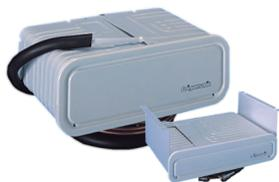
Todos los evaporadores Frigoboat serie H pueden usarse como compartimento congelador dentro de una nevera. Estos compartimentos del congelador pueden ser montado vertical u horizontalmente. Todos se suministran con una tapa cuando se usan horizontalmente. Se suministra con 2,8 m de cobre precargado tubería de refrigerante de serie (las extensiones de tubería están disponibles de 1 a 6 metros). Provisto de acoplamientos autosellados Frigoboat.
