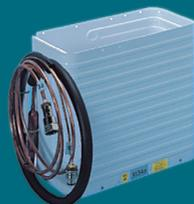
Todos los evaporadores Frigoboat serie B se pueden usar como congeladores compartimento dentro de una nevera o como un congelador dedicado. Estos compartimentos del congelador se pueden montar verticalmente o horizontalmente. El 340B tiene una tapa opcional cuando se usa horizontalmente. Se suministra con 2,8 m de tubería de refrigerante de cobre precargada de serie (las extensiones de tubería están disponibles de 1 a 6 metros). Provisto de acoplamientos autosellados Frigoboat.
