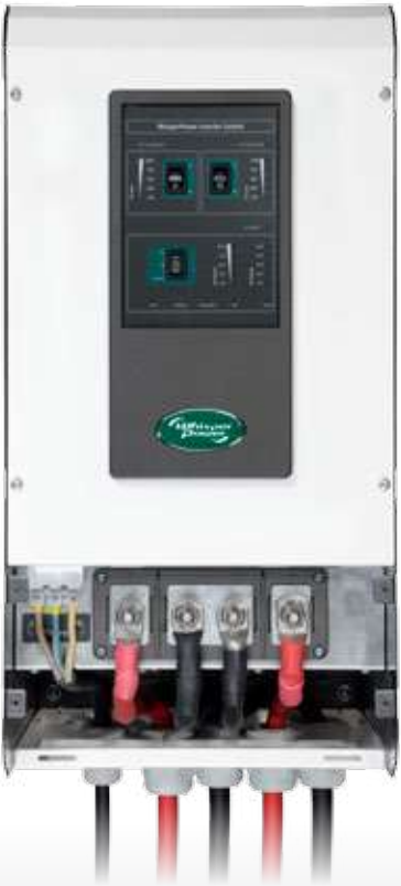
Compartimiento de conexión del 7kVA AC PowerCube . A la derecha, doble conector de batería con 2 conexiones de DC PLUS y 2 de DC MENOS – se pueden conectar una o dos bancos de baterías separados. A la izquierda, la potencia de salida 230 V / 50 Hz y la conexión para el panel de control remoto y los diversos puertos de montaje.
